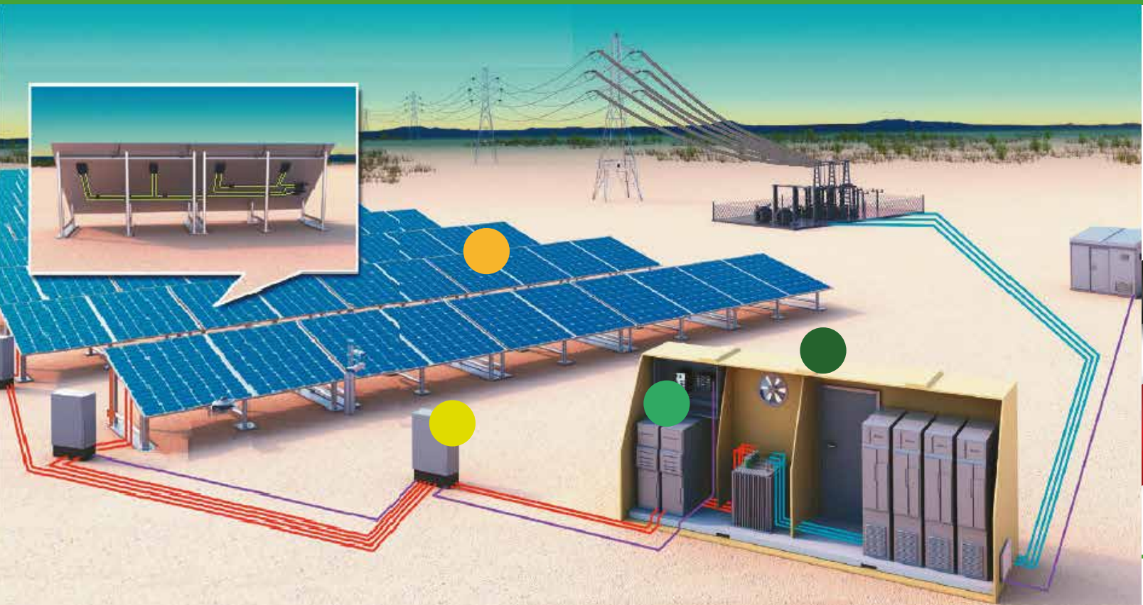
Figura 1 >> Sistema de cableado en Instalaciones fotovoltaicas.
